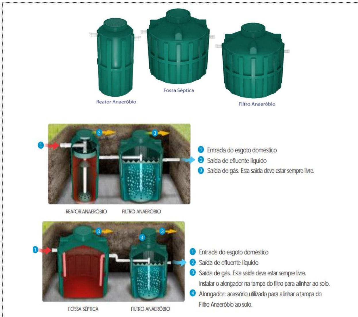
**Figura 4.2-XI: Modelo de ETED – Estação de Tratamento de Esgoto Domiciliar**
