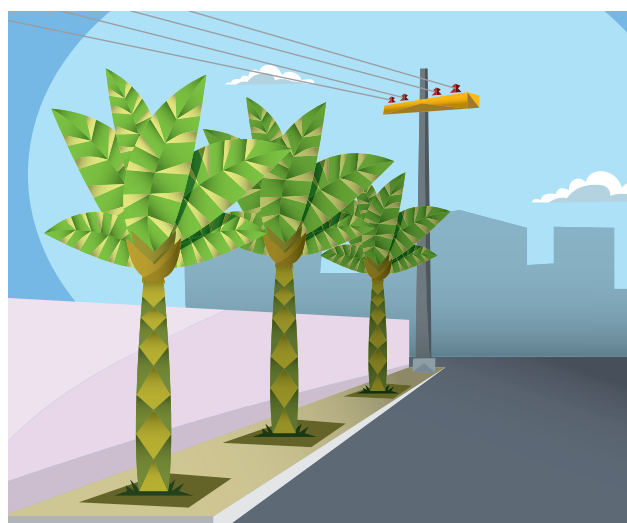
Figura 40: Plantio inadequado de Palmeiras sob rede elétrica.
