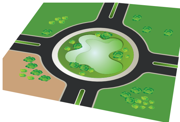
Figura 31: Proposição para uso das rotatórias como reservatório de águas pluviais (Fonte: Adaptado IPUP, 2015).
