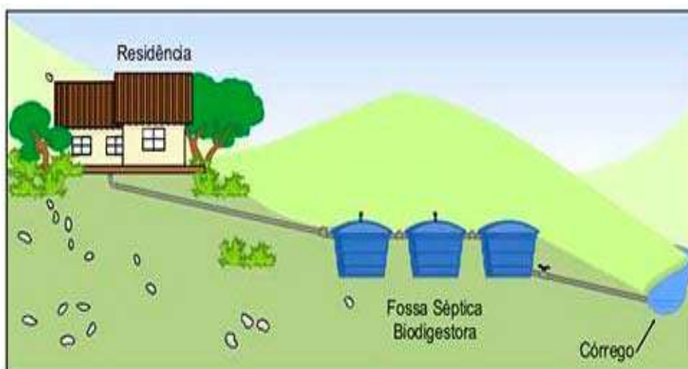
Figura 123. Modelo simplificado de tratamento de esgoto para comunidades rurais (EMBRAPA)
