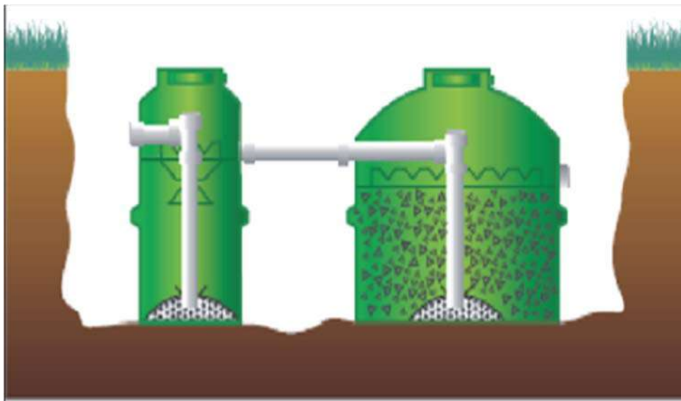
Figura 121. Modelo de fossa-filtro para atendimento domiciliar (ETED)
