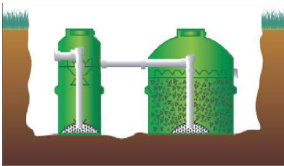
Figura 121. Modelo de fossa-filtro para atendimento domiciliar (ETED)
